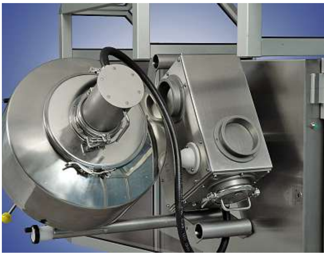
NIR Spektrometer an einer pharmazeutischen Produktionsmaschine.
