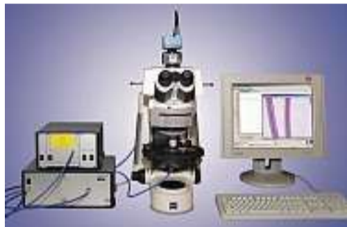
J&M Spektrometer an Mikroskopen verschiedener Hersteller.
